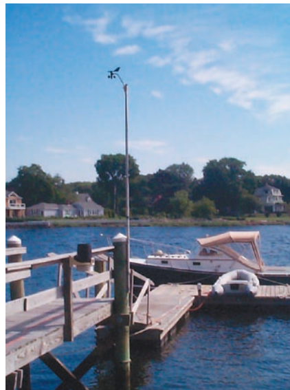
No rio Barrington em Rhode Island (EUA), William Harris tem um Vantage Pro e uma Estação sem Fio de Temperatura. No verão a estação informa se a água está própria para banho e, no inverno, alerta sobre a formação de gelo.
