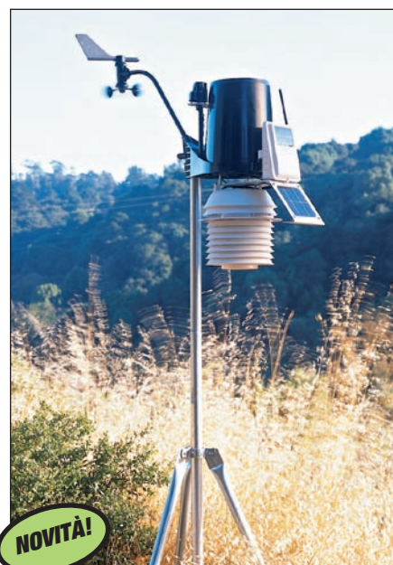
6328 con schermo solare ventilato 24 ore su 24
